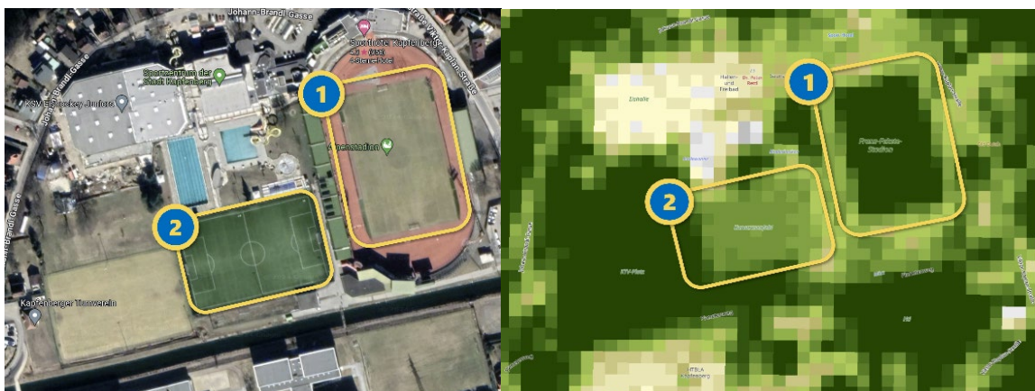
Fig. 29: Couleurs réelles vs. image NDVI
