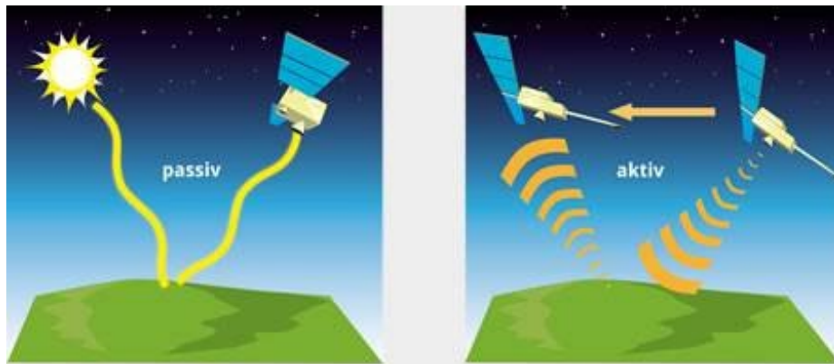
Fig. 10 : Systèmes d'enregistrement passifs et actifs de l'observation de la Terre.
