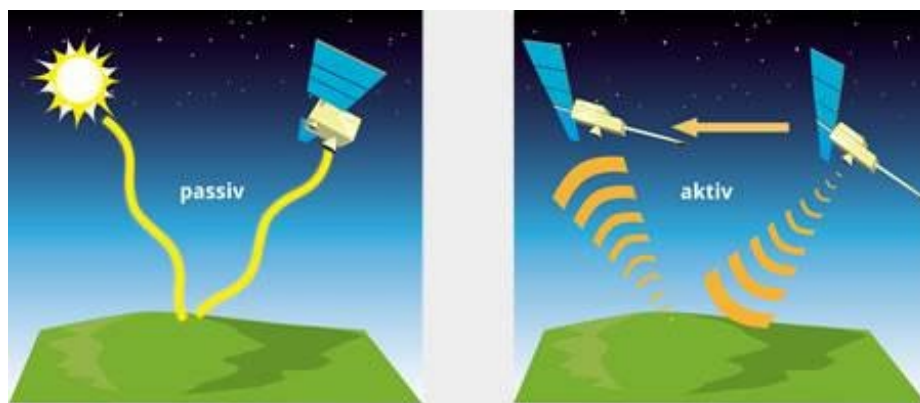
Abb. 10: Passive und aktive Aufnahmesysteme der Erdbeobachtung.
